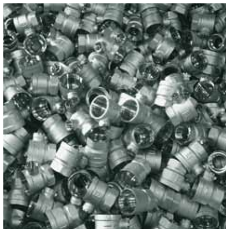
Ventilhus, varje år produceras cirka 10 miljoner ventiler.
